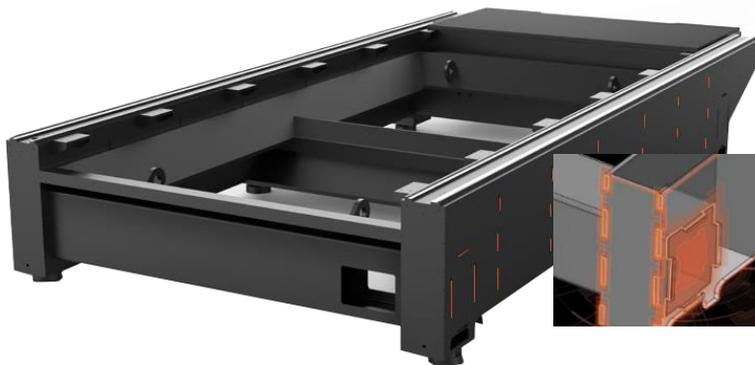
Cada pieza se ensambla aprovechando al máximo la fuerza estructural y se fija con soldadura.
