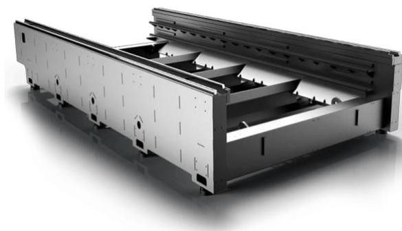
Cada pieza que constituye la cama se ensambla mediante el sistema de mortaja y espiga y después se suelda. Este sistema, heredado de la fabricación tradicional china de mobiliario, consigue una solidez y resistencia máximas para hacer frente a la fabricación industrial en largos turnos de producción manteniendo una buena estabilidad y resistencia a la vibración.
